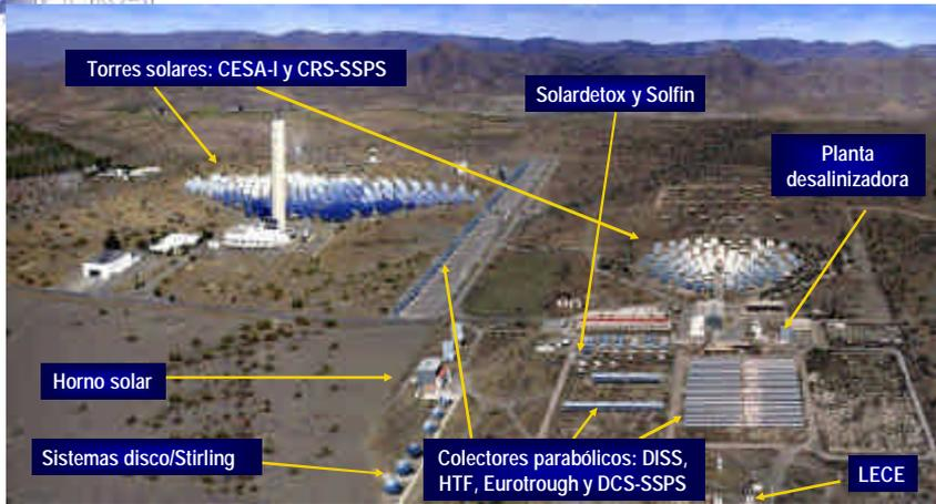
ENEA - CIEMAT - Hacia un diseño óptimo y construcción de una planta de energía modular, de 50 Mwe, que incluya almacenamiento de energía y producción de hidrógeno.
